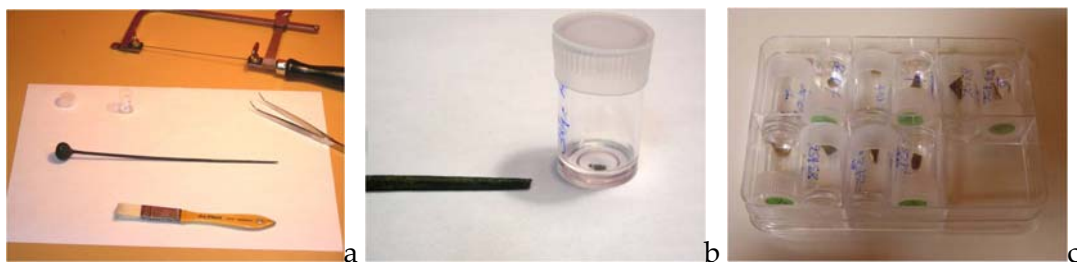
Fig. 6 : a. Photographie présentant les outils utilisés pour ce type de travail dont la scie d'horloger. b. Photographie présentant la taille d'un prélèvement. c. Photographie présentant l'enregistrement des prélèvements dans un pilulier [Clichés : Ewa Wyremblewski].
