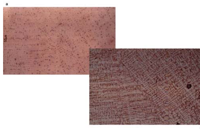
Fig. 9 : Photographies microscopiques d'échantillons présentant un état brut de coulé avant (a) et après attaque chimique (b) [Clichés : Ewa Wyremblewski].
